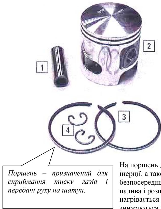
Поршнева група складається з поршня, поршневих кілець, поршневого пальця, деталей для утримання пальця від осьового переміщення, кріпильних деталей.
